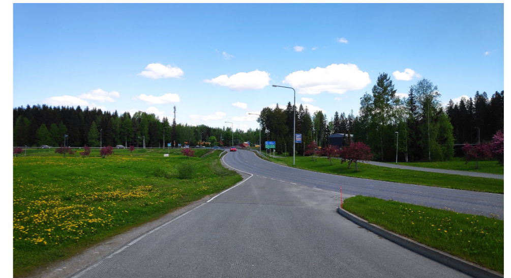
Kuva 4-5. Nykyinen Kirjauksentie hyödynnetään uuden eritasoliittymän ramppina.
